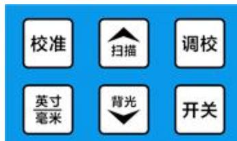
**开关** 键为开关键。开机后，仪器先进行自检。1秒后，显示仪器型号“L500”，然后显示“0.00”，表明仪器可以使用。关机后，可保存其所有设置。LK500 具有自动关机功能。如果 5 分钟不做任何操作，将自动关机。
