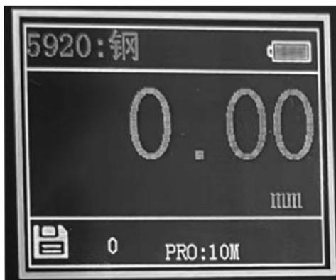
**耦合状态：** 探头与被测工件的耦合状态
